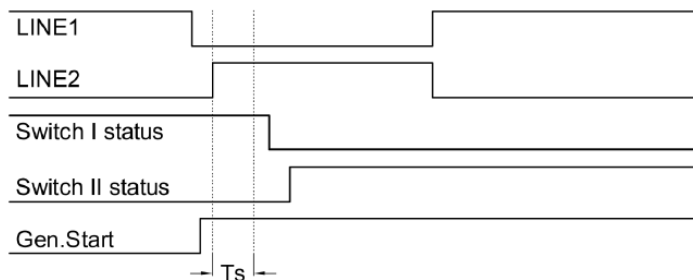
Obr. 4 Automatická spínací posloupnost přístroje OTM_C_21D, Režim ručního zpětného přepnutí
